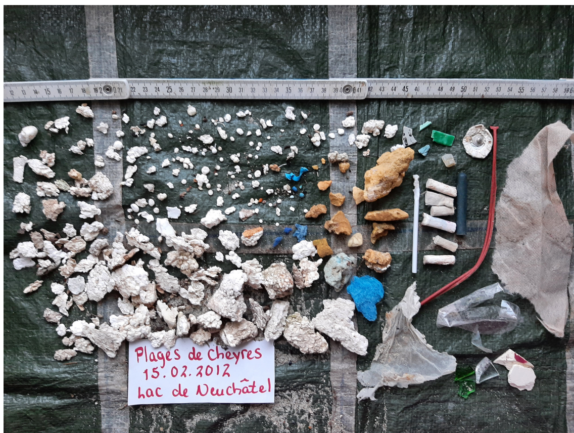
Verschiedene Grössen von weissem expandiertem Polystyrol und anderen Schaumstoffen
